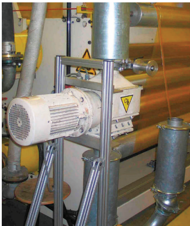
Устройство для измельчения пленки Getecha можно легко установить с помощью двух компенсаторов непосредственно в трубопровод вытяжного воздуха (все фото: Getecha)
